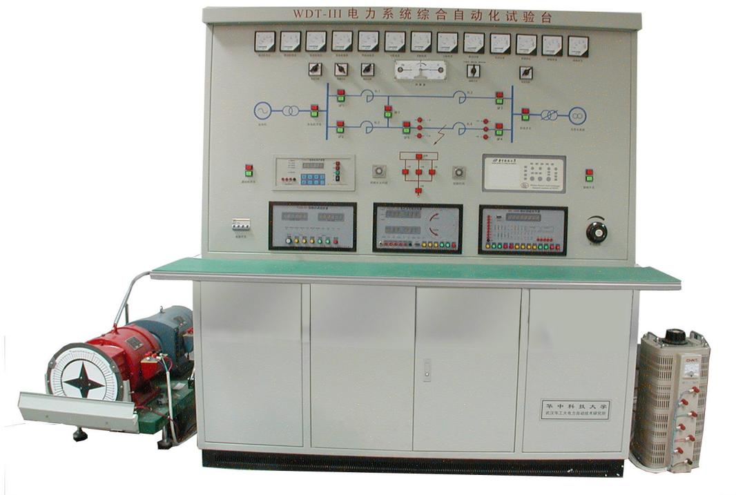
图1 WDT-III型电力系统综合自动化试验装置现场图
